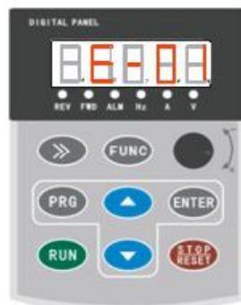
图 1-5 加速中过流故障报警显示
